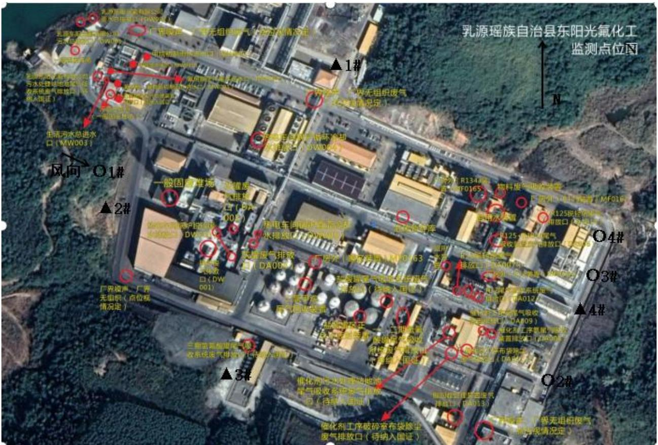
图 7.1-1 废水、有组织废气、无组织废气、噪声监测布点图
